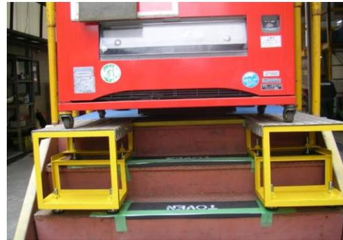
⑩ 補助具を撤去して、補助輪を格納し下降へと進める。
